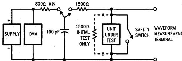
**FIGURE 1-23. ESD Test Circuit**
