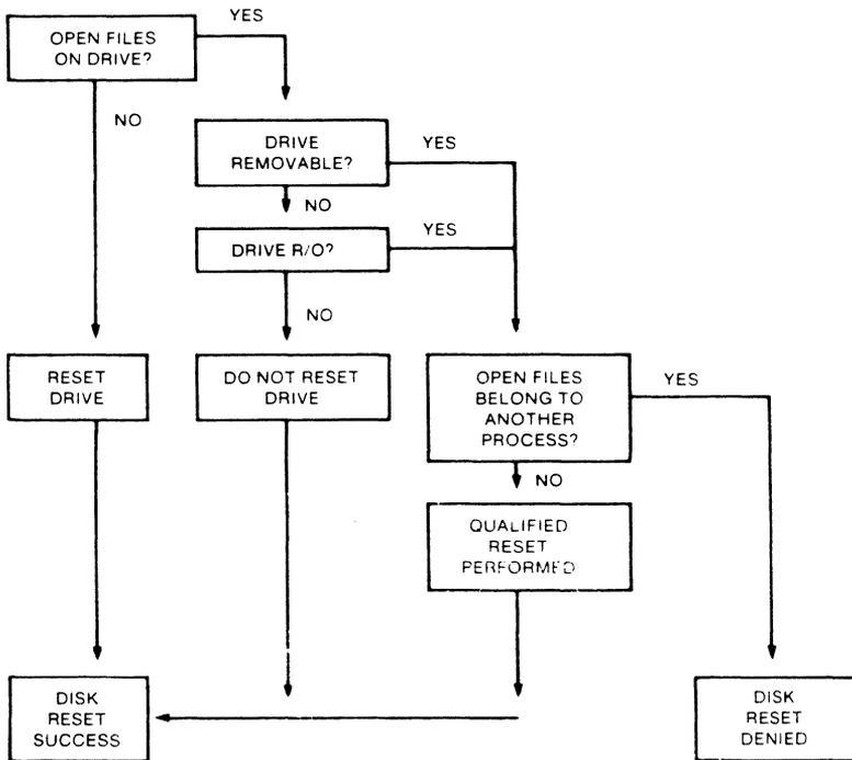
Figure 2-8. Disk System Reset
