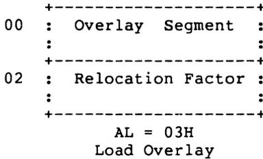
**Figure 7-9. EXEC Load Overlay Parameter Block**
