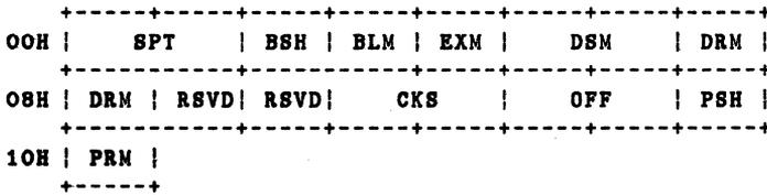
**Figure 6-4. DPB - Disk Parameter Block**
