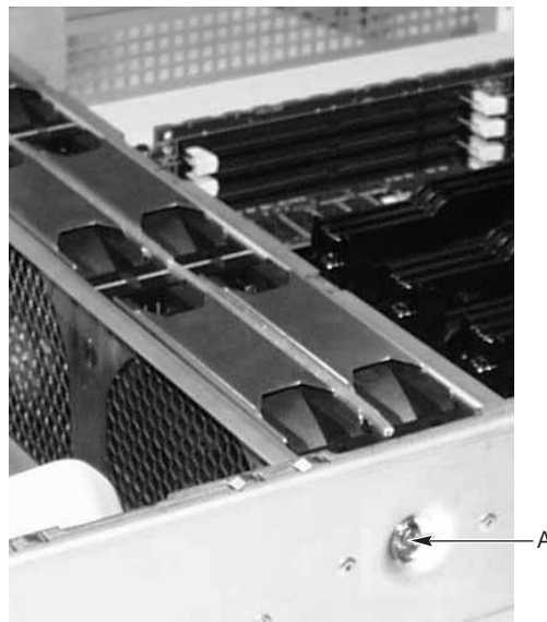
Figure 30. Une des deux vis fixant l'assemblage de cartes de ventilateur
