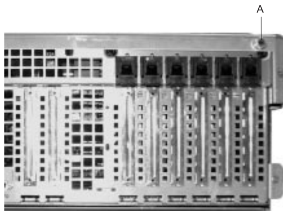
Рисунок 2. Один из двух винтов-барашков, удерживающих верхнюю крышку
