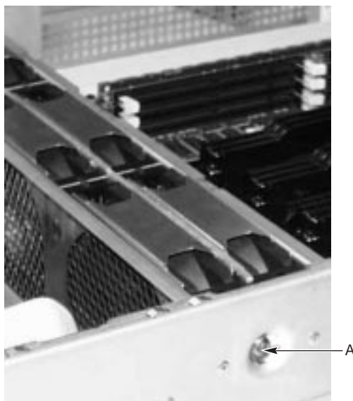
Рисунок 30. Один из двух винтов, удерживающих вентиляторную сборку
