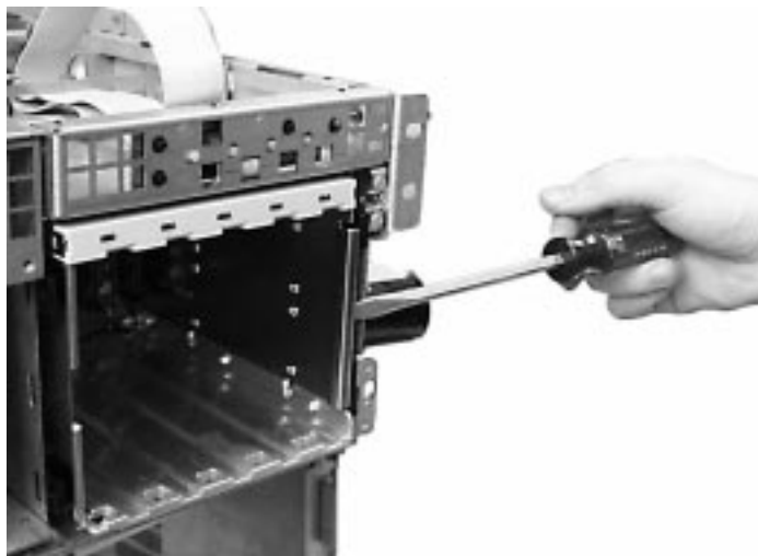
Рисунок 33. Удаление секции жестких дисков из шасси
