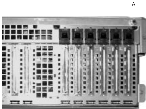
Рисунок 13. Один из двух винтов-барашков, удерживающих верхнюю крышку
