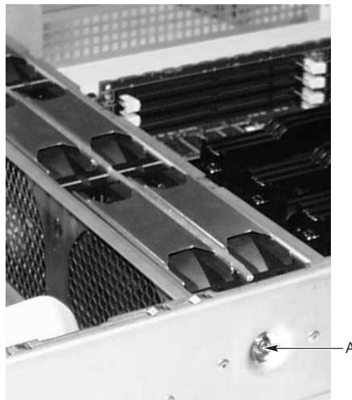
Figura 30. Uno de los dos tornillos que aseguran el ensamblaje de la tarjeta de ventilación
