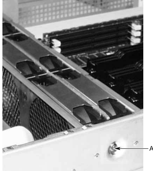
圖 30. 固定風扇板組件兩顆螺絲的其中一顆
