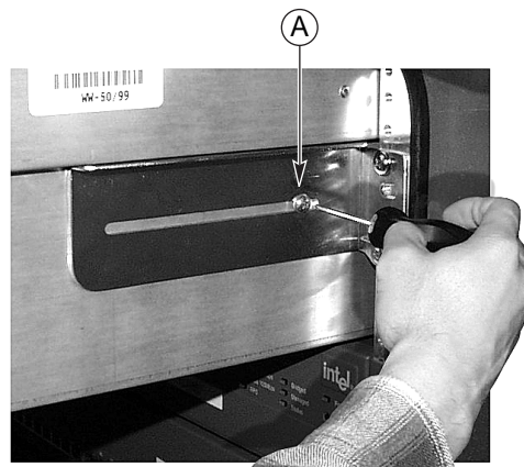
Abbildung 16. Gehäuse wird mit Schraube „A“ an der Halterung befestigt
