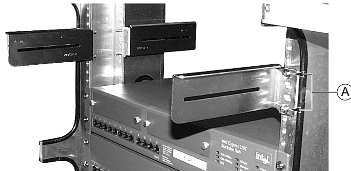
Abbildung 14. FR/RL-Halterung am linken hinteren Ende des Racks
