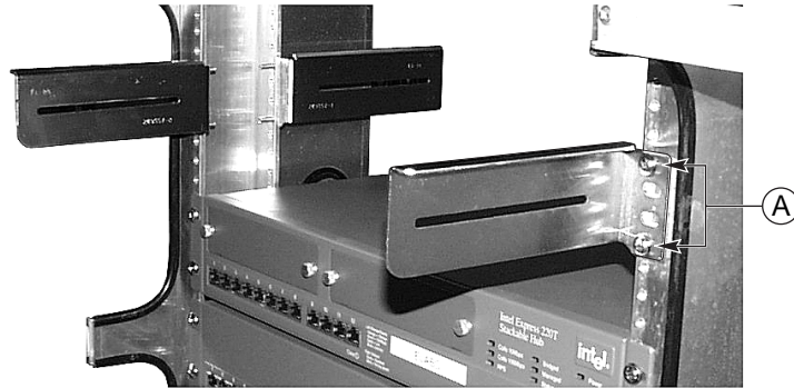
Figura 14. Soporte FR/RL acoplado al lado posterior izquierdo del bastidor
