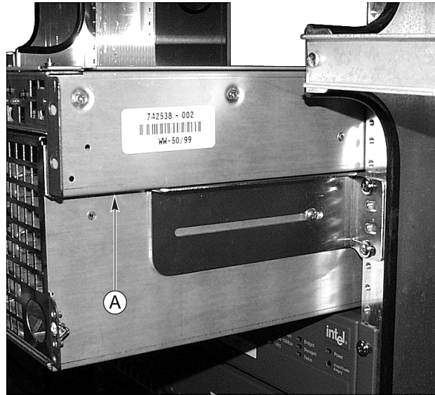
Figura 15. La carcasa se desliza y encaja en el bastidor
