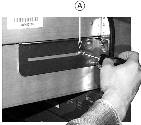
Figura 16. La carcasa queda fijada al soporte mediante un tornillo que aparece marcado con la letra "A"
