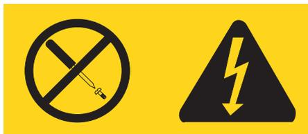
Voltaggio, tensione e livelli di energia pericolosi sono presenti all'interno di qualsiasi componente che presenti questa etichetta. All'interno di tali componenti non vi sono parti su cui effettuare l'assistenza tecnica. Se si ritiene di essere in presenza di un problema relativo a tali parti, contattare un tecnico di manutenzione.
