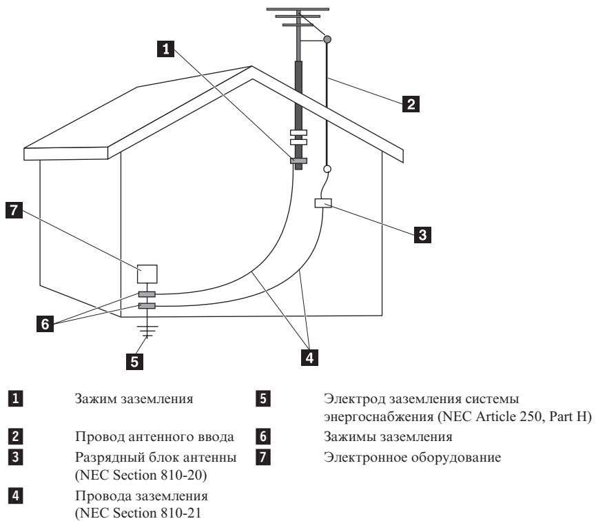
Рисунок 1. Правильное заземление для кабеля
