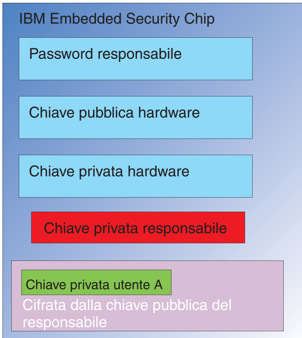
Figura 6. La chiave privata dell'Utente A' cifrata dalla chiave pubblica del responsabile, viene passata nel chip di sicurezza.
